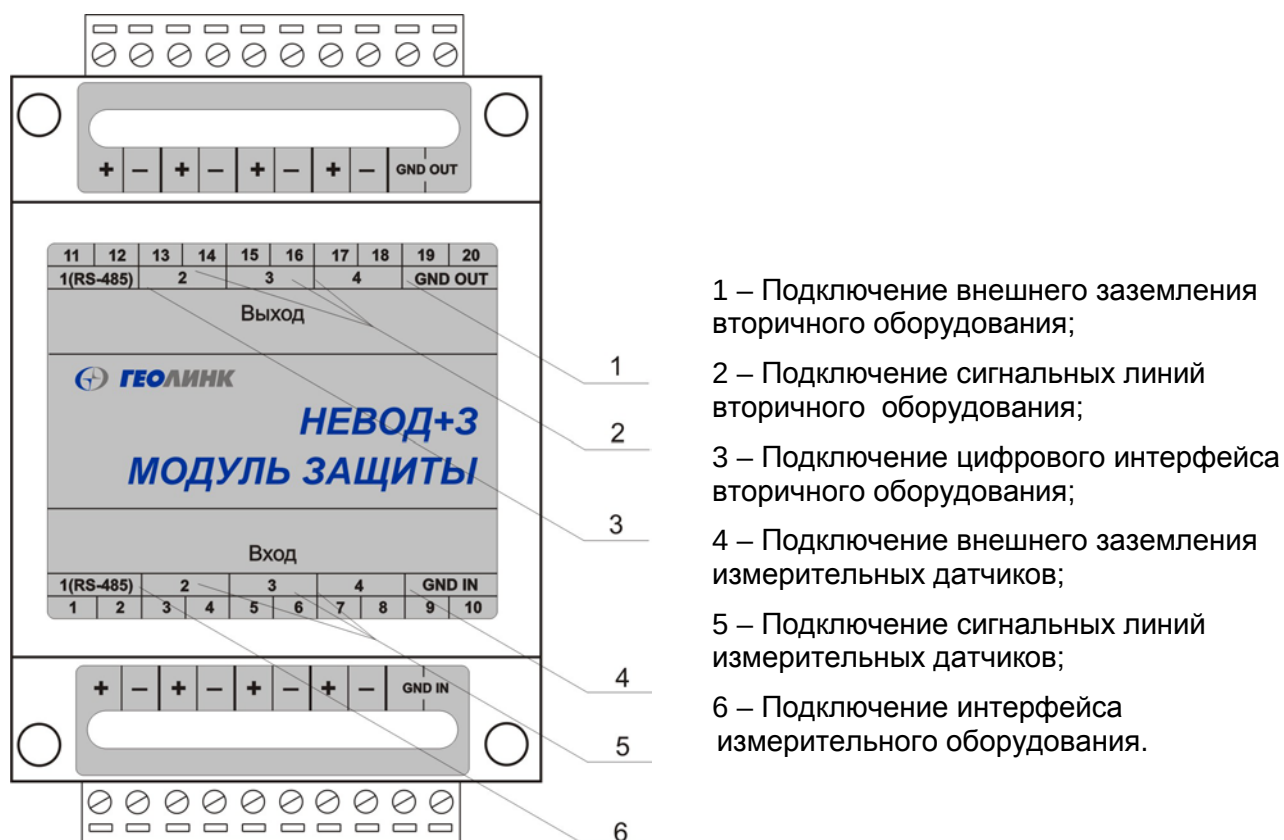
Рис. 1. Назначение выводов клеммных колодок
